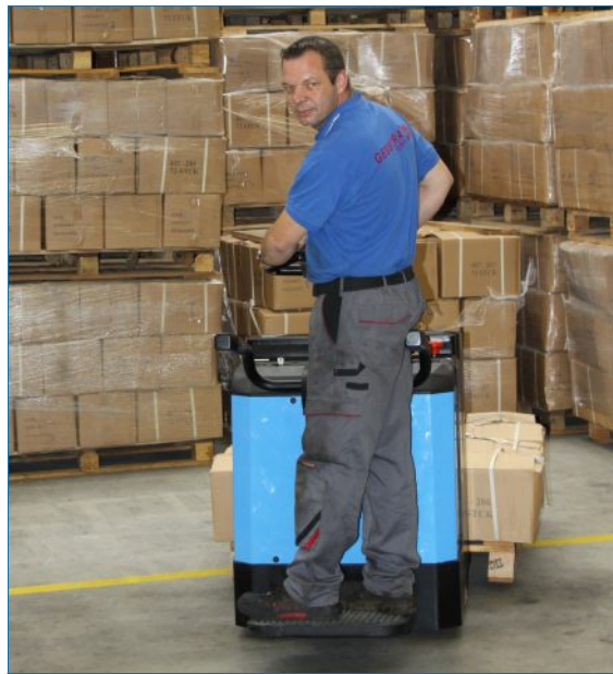
MODELL E-20-PL-AC: Hochwertige stoßgedämpfte Mitfahrerplattform mit Antirutschbelag als Standard.
